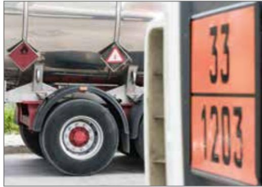
Bei Mehrkammerfahrzeugen können je nach Ladung seitlich unterschiedliche Nummern angezeigt werden, während die vordere und hintere Tafel ohne Ziffern ist.
